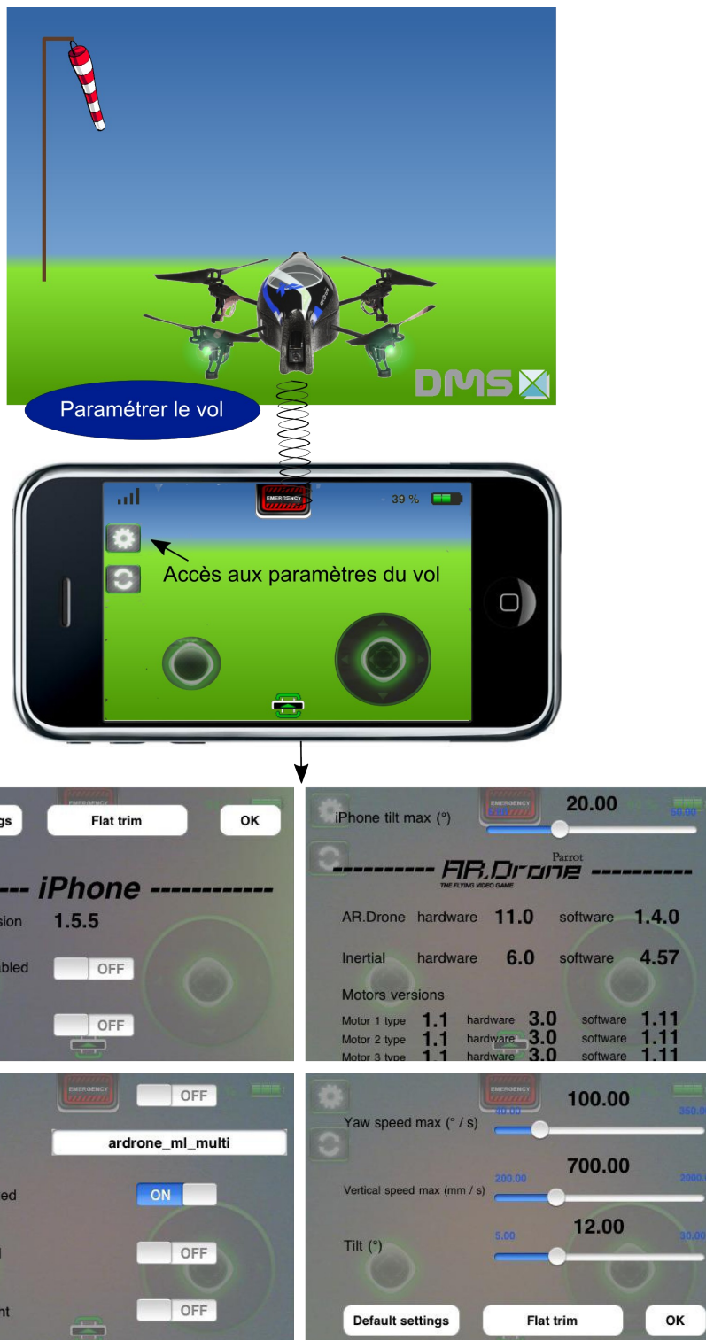
Fig. 24: Paramétrage du vol depuis la Station-Sol
