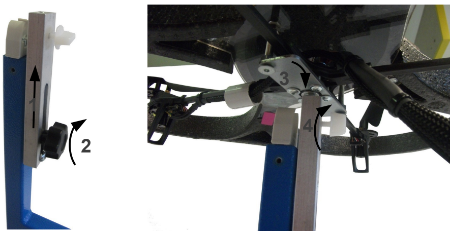
Fig. 112: Fixation de la croix centrale en position "Orienter"
