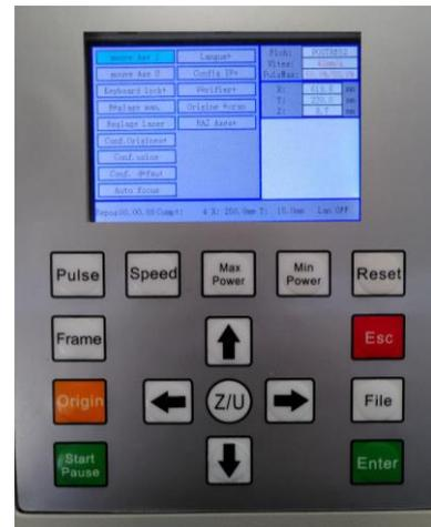
Sur le logiciel réaliser un test avec le bouton « Cadre » afin de vérifier la surface impacté par le prototype
