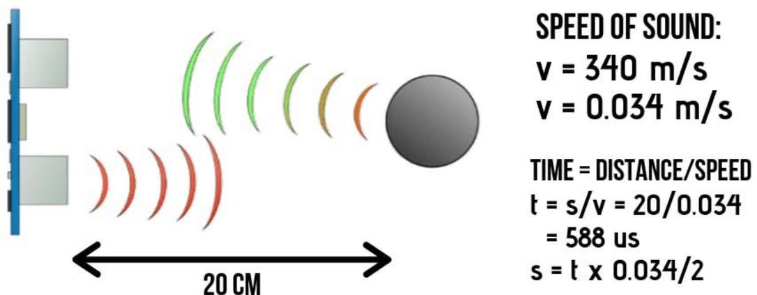
4. Le capteur détecte l'écho et clôture la prise de mesure.
