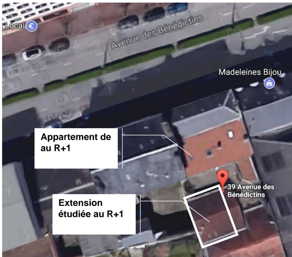
L'extension prendra la place de la structure entourée sur le schéma qui va être détruite. Elle se situe sur une terrasse au R+1, sous laquelle se trouve des garages.
