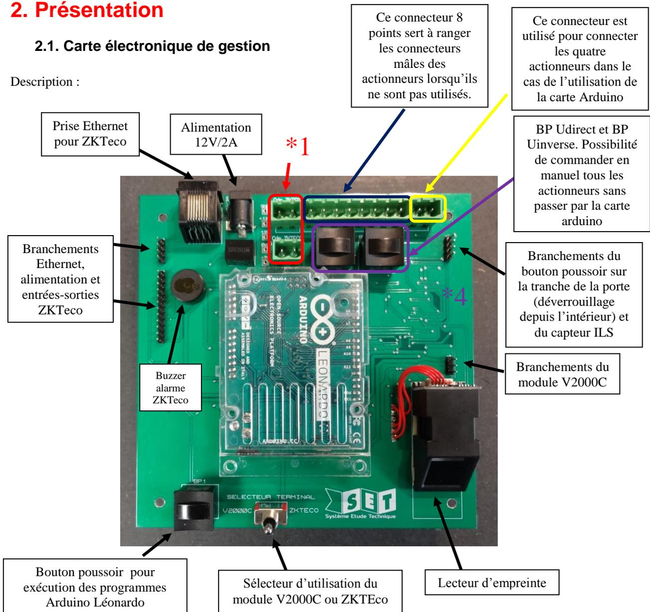
**\*1** : Ces connecteurs servent à la commande des actionneurs depuis le module ZKTeco du verrou électrique, de la ventouse électromagnétique ou de la gâche électrique. Celui du haut est un contact NO 12 volts pour l'utilisation de la gâche électrique. Le connecteur en bas est constitué d'un contact NF 12volts pour la connexion des deux autres actionneurs.
