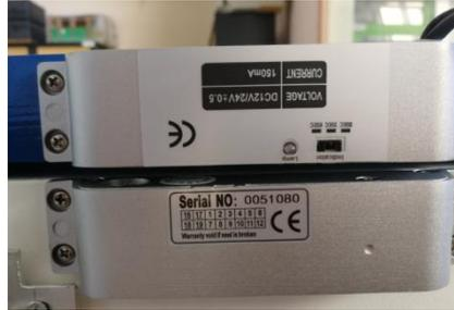
Pour que l'accès puisse être interdit, l'actionneur doit être alimenté. Le pêne est alors sorti. Lors de l'arrêt de son alimentation, le pêne reprend sa position d'origine. Le verrou intègre un capteur ILS de position. Ce système indique le bon alignement des deux éléments qui constitue le verrou.
