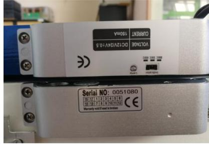
Pour que l'accès puisse être interdit, l'actionneur (électro-aimant) doit être alimenté. Le pêne est alors sorti. Lors de l'arrêt de son alimentation, le pêne reprend sa position d'origine. Le verrou intègre un capteur ILS de position. Ce système indique le bon alignement des deux éléments qui constitue le verrou.
